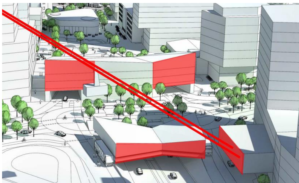
Figur 14. Fasaders och linors (rödmarkerade) placering ovan Götatunnelns mynningar.
